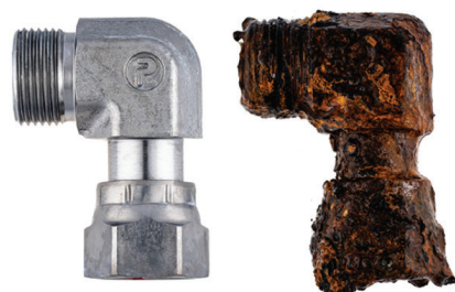
ToughShield Plus (esquerda) e tratamento zinco convencional (direita) após 3000 horas de Teste Salt-Spray (SST)
